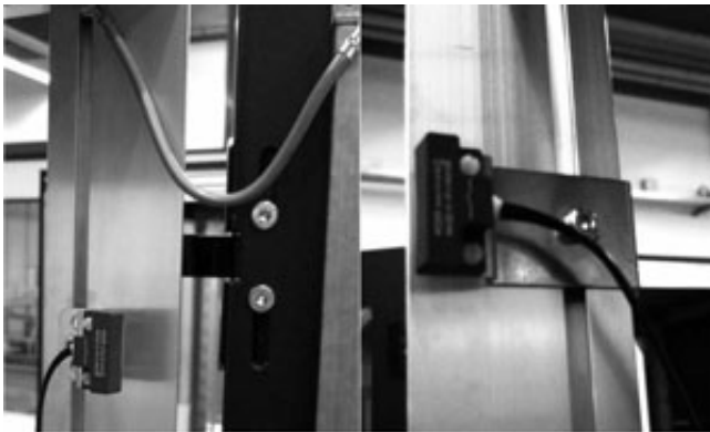
Рис. 7. Способ монтажа датчиков контроля открытия двери
