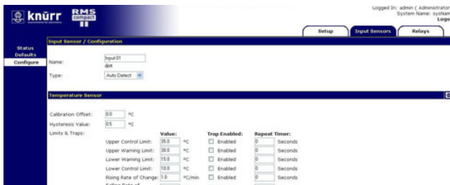
Рис. 6. Фрагмент экрана web-интерфейса конфигурации RMS-2 (англоязычный)
